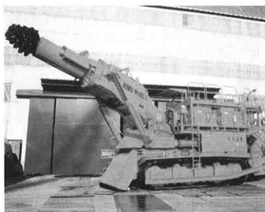
自由断面掘削機(RH-10J型ブームヘッダー)全景
