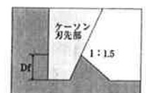
Df=刃先掘入れ長(掘り残し量)
