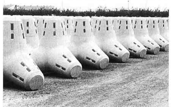
イオンカルチャープレートを装着したテトラポッド
